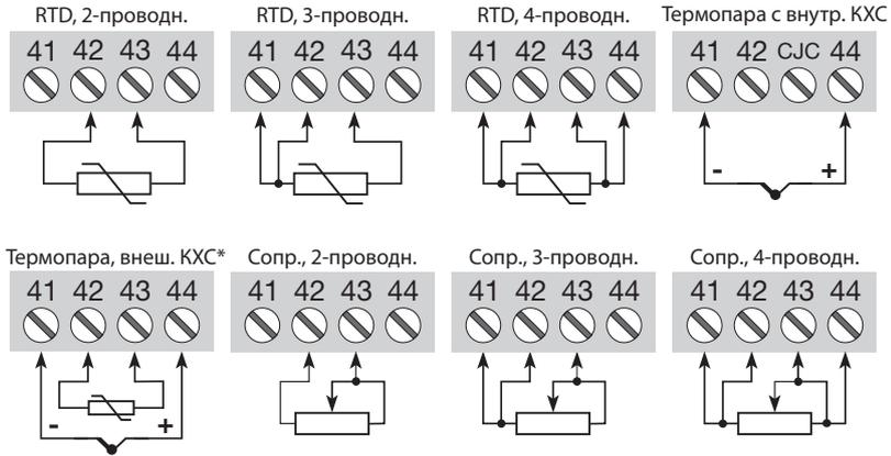
\* В случае перепрограммирования с измерения температуры через разъем с КХС на аналоговое измерение следует демонтировать разъем КХС.
