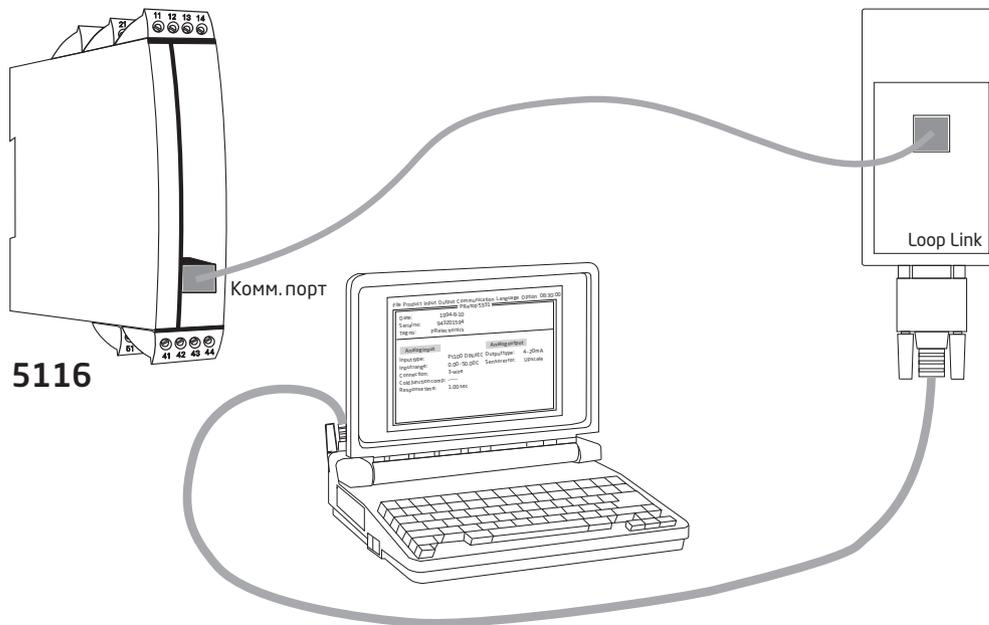
При подсоединении модуля 5116В к интерфейсу Loop Link следуйте нормам искробезопасной установки.
